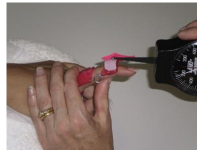
Orthèse type Capener avec mesure de la force appliquée avec la jauge Haldex®
