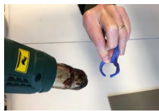
Fig.55 : Décapeur thermique et adaptation d'une orthèse avec celui-ci.
