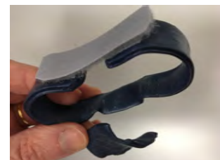
Fig.71 : Décollement de la languette de limitation par mauvais collage.
