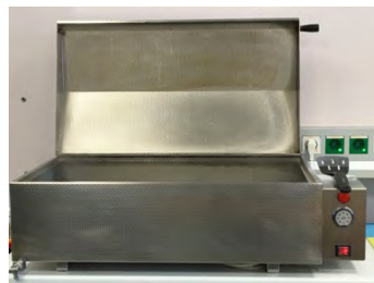
Fig.51 : Bac d'eau chaude.
