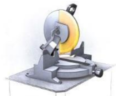
Protecteur réglable de scie à onglet à réglage automatique lors de la descente de lame
