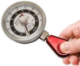
Dynamomètre Hydraulique pour une mesure de la Key Grip [29]
